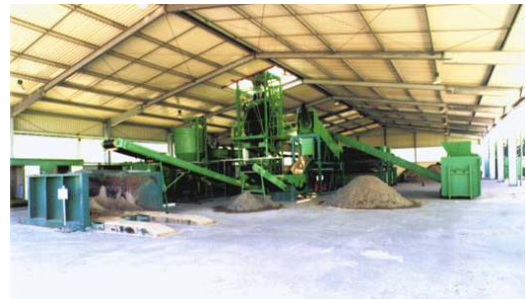
Fig. 1: Planta móvil para el lavado del suelo TERRALAVAR®
